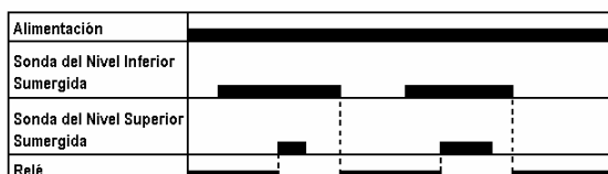
Carga (Llenado) de Depósitos
